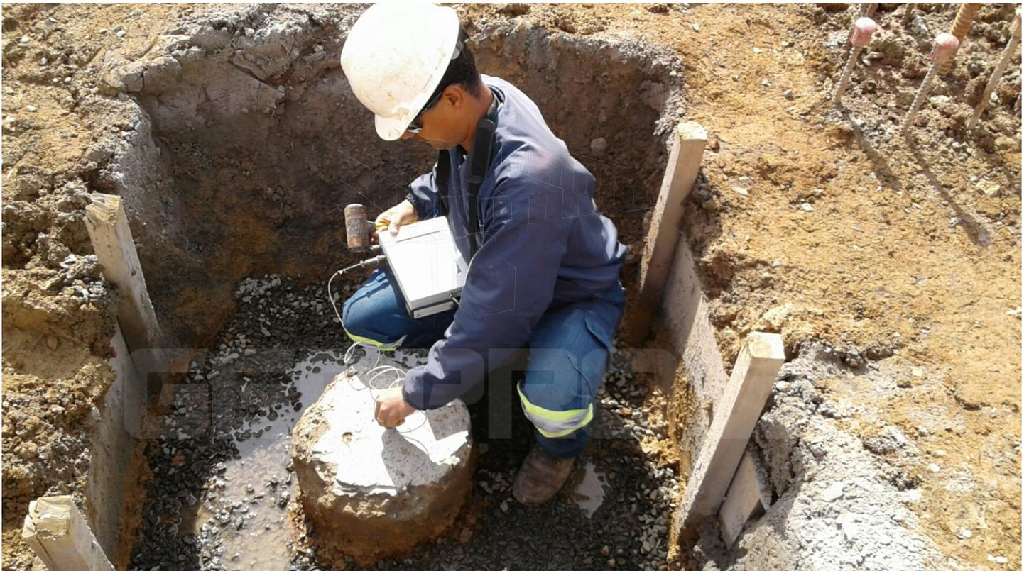
O [ensaio PIT](#) é um teste não destrutivo, utilizado para avaliação da integridade das estacas ao longo de seu comprimento e também pode fornecer outras informações, como o comprimento total executado. Seu principal objetivo é o mapeamento de inconformidades do processo executivo, tais como concretos de má qualidade, bicheiras, variações na seção de concreto, entre outras.
